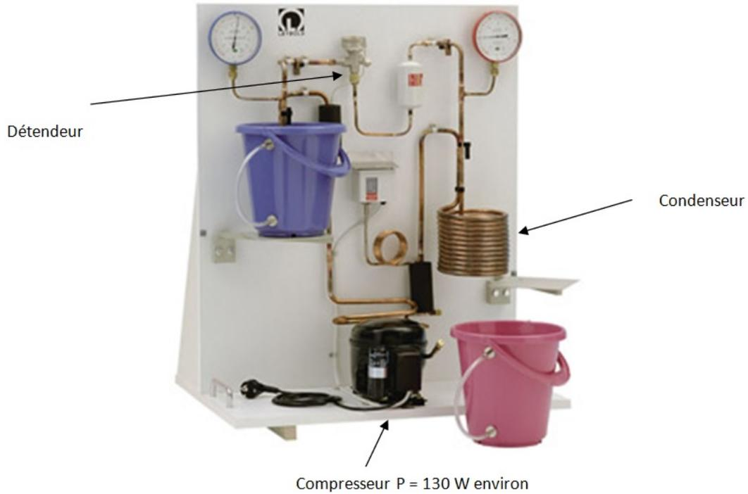
On a déjà réalisé des mesures de températures d'eau à l'intérieur des deux seaux rouge ( $T_r$ ) et bleu ( $T_c$ ).
